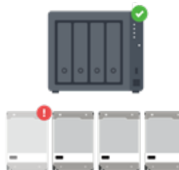
RAID 5では1台の HDD 故障 時でも連続稼働が可能
